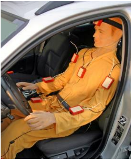
Bild 1: Der DRESSMAN besteht aus einem Overall, auf dem bis zu 32 beheizte Klimasensoren variabel befestigt werden können.
